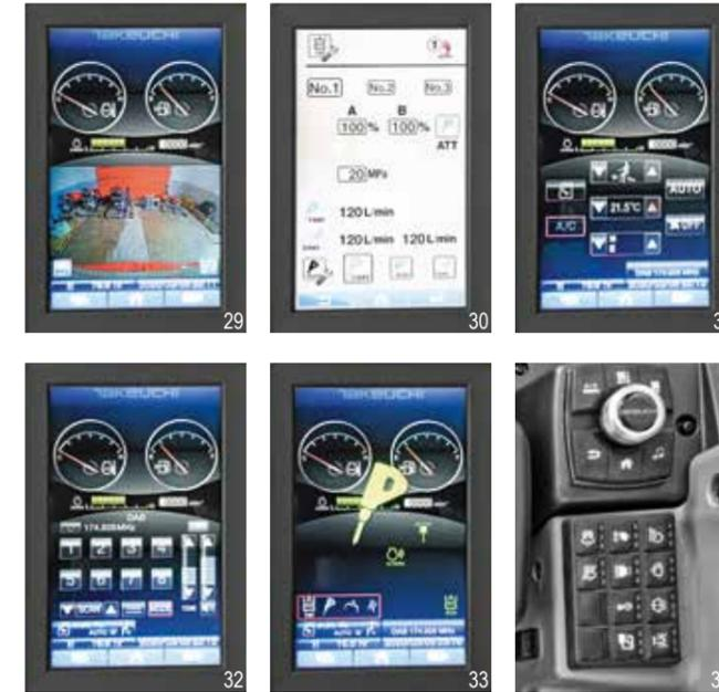
Erstmals verbaut Takeuchi einen 8-Zoll-Farb-Touchscreen samt Jog-Dial-Bedienelement. Auf diesem Hauptbildschirm informieren Sie sich ganz einfach über die aktuellen Betriebszustände der Maschine oder steuern Klimaanlage bzw. Radio. Auch die unterschiedlich eingestellten Druck- und Litermengen für den ersten Zusatzkreis können Sie hier abrufen. Weitere Vorteile:
