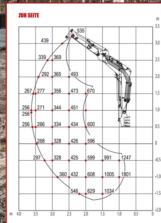
Die Hublasten in den Grafiken betragen bis zu 87% der hydraulischen Hublast bzw. bis zu 75% der Kipplast. Die Werte sind in Kilogramm angegeben – ohne Powertilt. Spurbreite 1.500 mm. Technische Änderungen vorbehalten.
