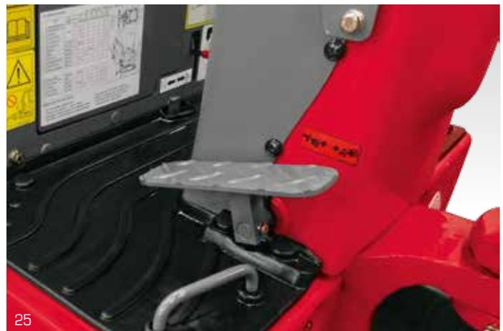
Mit dem rechten Fußpedal wird der Ausleger nach rechts oder links geschwenkt.
