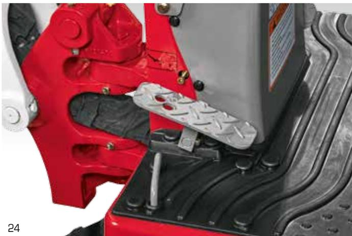
Durch das Fußpedal links kann die Zusatzhydraulik über ein doppelt wirkendes Ventil gesteuert werden.
